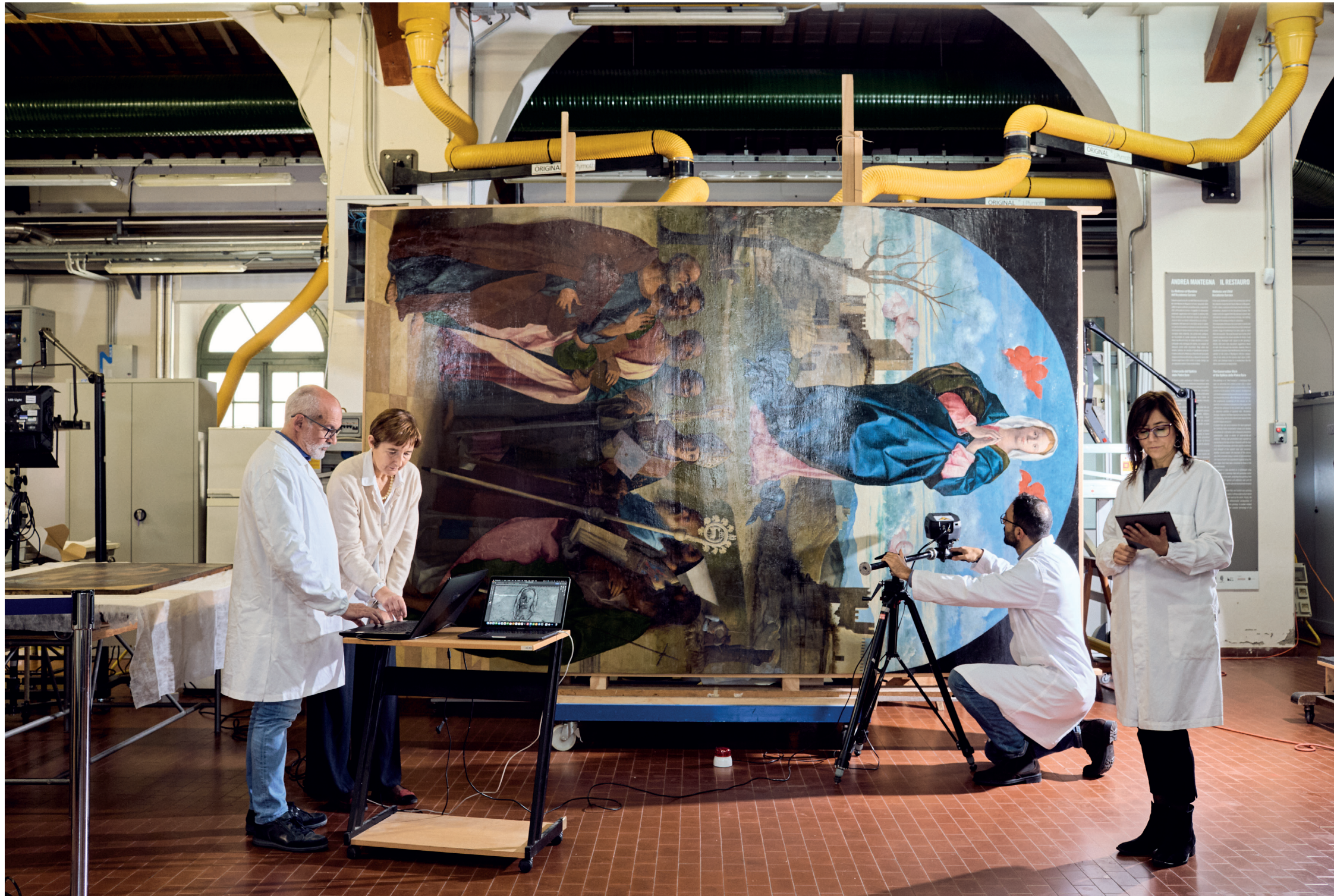
Laboratorio tele, Opificio delle Pietre Dure, Firenze Indagini diagnostiche con spettroscopia di fluorescenza a raggi X © Mattia Zoppellaro / Gramma Studio
